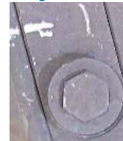
rostbeständiges Blech belegt mit \text{MnO}_2
